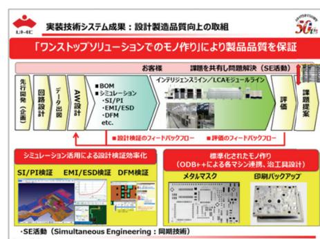
また、DFM 検証により後戻りのない設計を実現します。CAD の DRC では検出できないクリエイカルな課題のチェックを実施し、試作レスを目指します。SMD ランド設計では開口率やはんだ抜け性を事前に検証することで、製造工程での「はんだ付け不良」を未然に防ぐ取組みをしています。部品レイアウト検証では基板切り離し部とのクリアランスチェックなどにより、実装・基板分割または経年劣化のリスク箇所を検出しています。チェック時のルールは、過去トラの積み上げにより、UMC 内のプリント基板設計基準書を基に設定しています。
